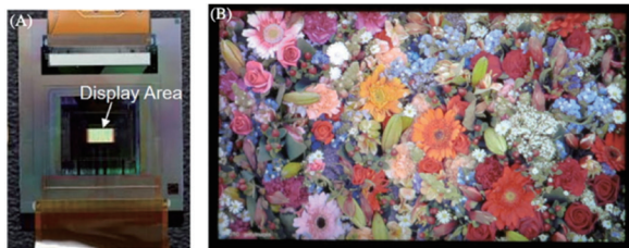
그림 3. SEL에서 60 nm CAAC IGZO TFT를 이용하여 개발한 5291 ppi OLED display 패널 [11]
